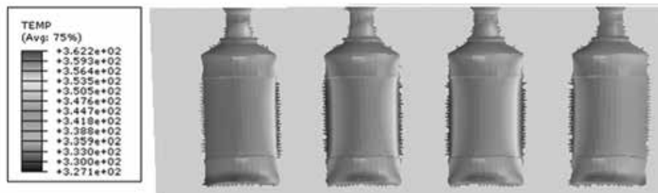
Rys. 3. Rozkład temperatury w gniazdach formy modelu nr 1 w 10 sekundzie symulacji (opracowanie własne)
