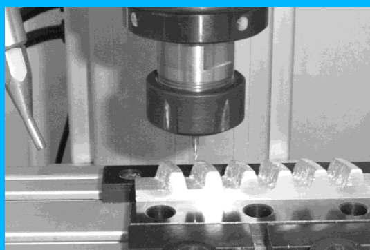
Rys. 4 Obróbka części ( Pic. 4 Part tooling)
